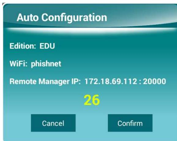
2. Une fois ces nouveaux paramètres mis en application, l'appareil NovoPRO indique automatiquement sa présence au Remote Manager. Vous pouvez cliquer sur le bouton Détection d'appareils puis sur le bouton Appareils détectés pour faire apparaître une boîte de dialogue de détection, d'où vous pouvez consulter la liste des appareils NovoPRO et ajouter ces derniers à la liste des appareils de Remote Manager.
