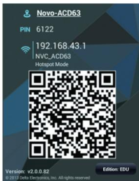
Le réglage par défaut de NovoCast est réglé sur le mode Point d'accès. La connexion se fait directement sur le SSID diffusé par l'appareil.
