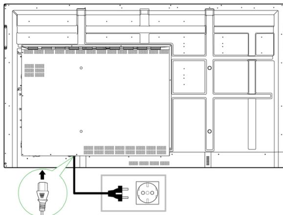
2. Mettez l'interrupteur d'alimentation situé dans la partie inférieure de l'écran en position Marche.
