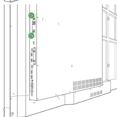
4. Installare l'antenna sul connettore del modulo OPS.
