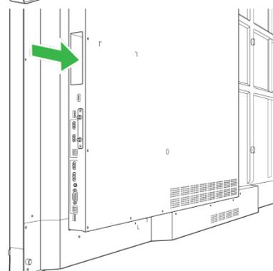
3. Serrare le due viti di blocco sul modulo OPS finché il modulo non è fissato correttamente al display.
