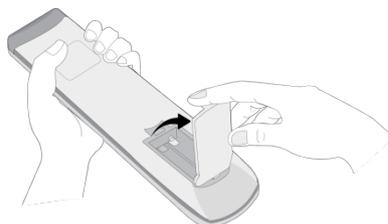
2. Inserire le batterie accertandosi che i terminali + e - sulla batteria corrispondano ai rispettivi terminali all'interno del vano batterie.
